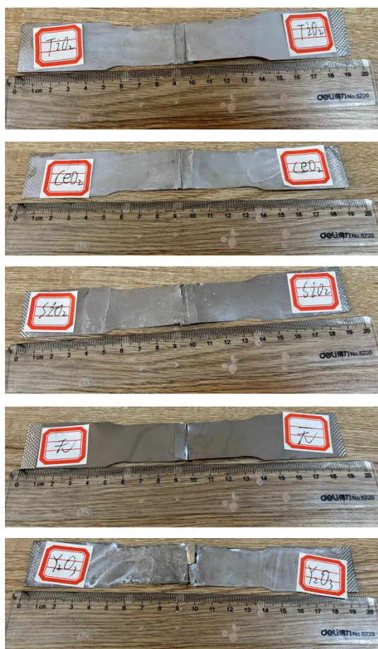
图10 不同焊接接头的拉伸断裂宏观形貌
